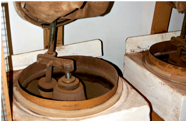
Blick in eine Schmalzlermühle
