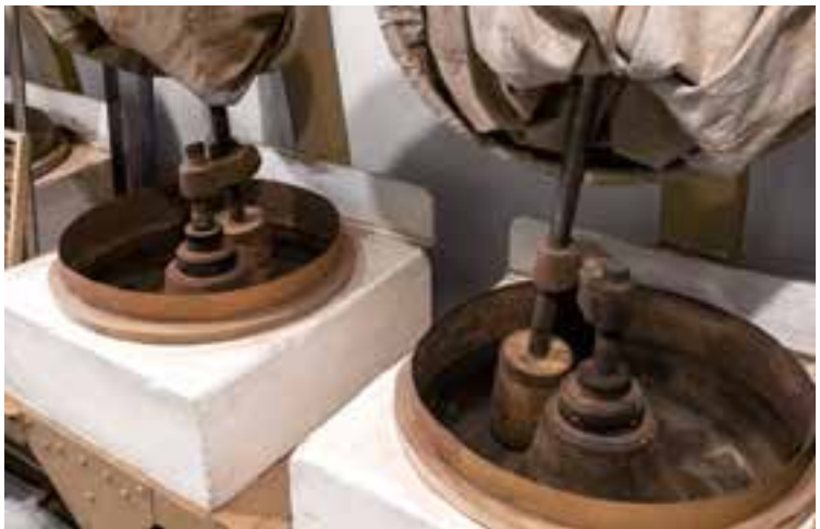
Blick in einen Reibstuhl
